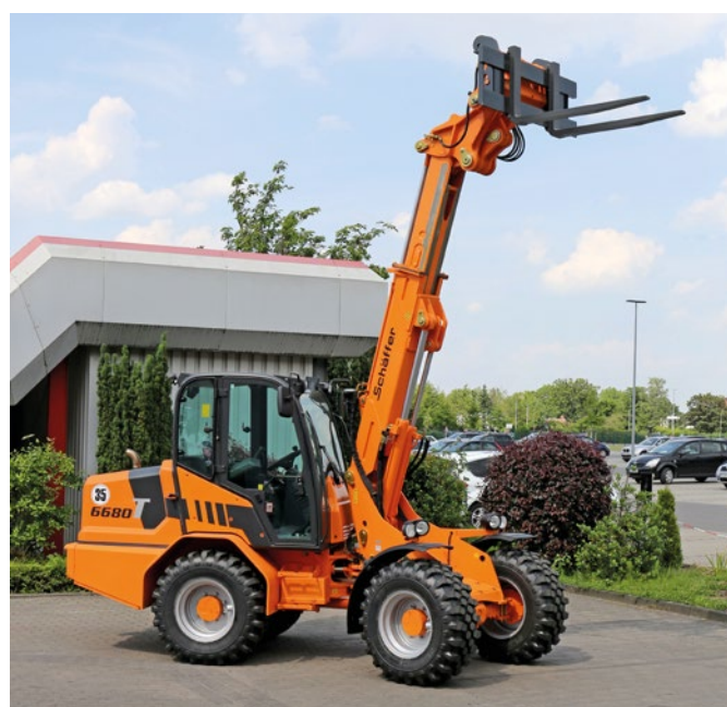
Avec une hauteur de levage de 4,95 m au point de pivotement de l'outil, la 6680 T est idéale pour le chargement et l'empilage de palettes ainsi que pour le chargement de saieuses et autres épandeurs.
