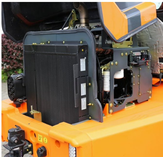
Le moteur Deutz dernière génération de 75 ch est conforme à la norme antipollution Stage V. Tous les points d'entretien sont facilement accessibles.
