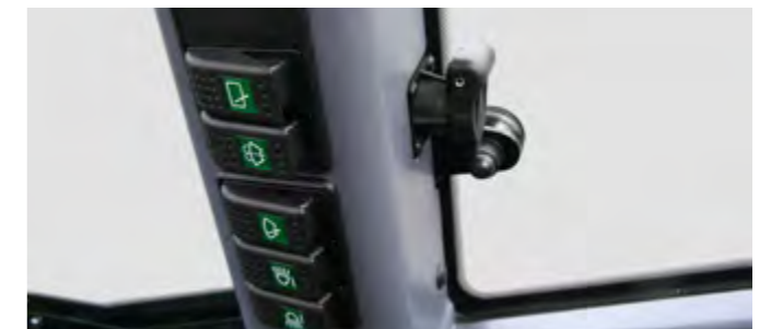
Zusammengefasste Schalterleiste, Steckdose mit Dauerstrom
