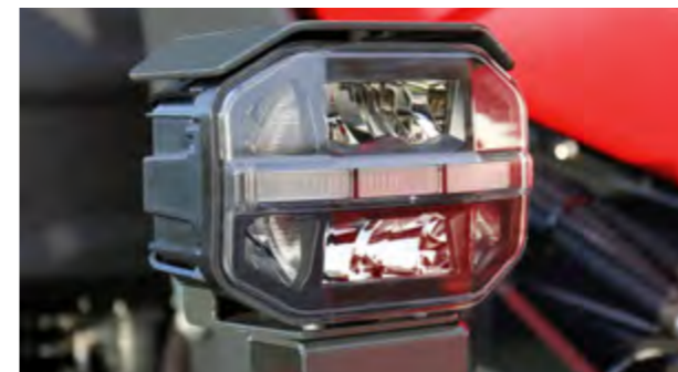
Die Fahrscheinwerfer sind in LED-Ausführung und mit Tagfahrlicht ausgestattet.
