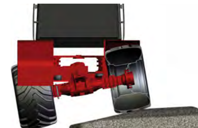
Die Pendelachse bringt ein großes Plus an Standfestigkeit. Mit der optionalen Pendelachsfederung noch komfortabler und sicherer.
