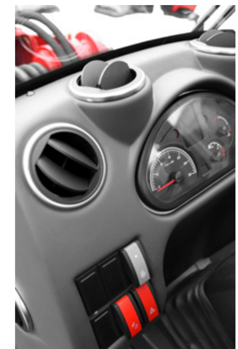
Zusätzliche, größere Luftauslässe für optimale Luftzirkulation / optimierte Schalterbaureihe
