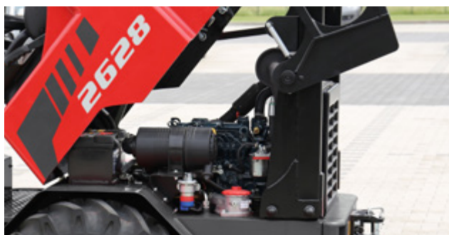
Le capot moteur s'ouvre vers l'avant. Tous les points de service sont facilement accessibles, des deux côtés de la machine.
